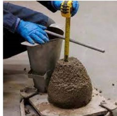
Figure 2. Mesure de l'affaissement du béton au cône d'Abrams.
