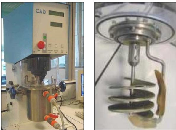
Figure 7. Rhéomètre à mortier RHEOCAD, avec une pale rugueuse en forme d'hélice et une contre-pale.
