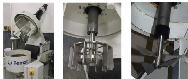
Figure 9. Rhéomètre à béton RheoZyklos.
