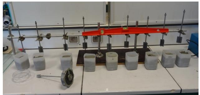
Figure 18. Banc de pales scissométriques permettant de mesurer le seuil à 9 échéances successives.
