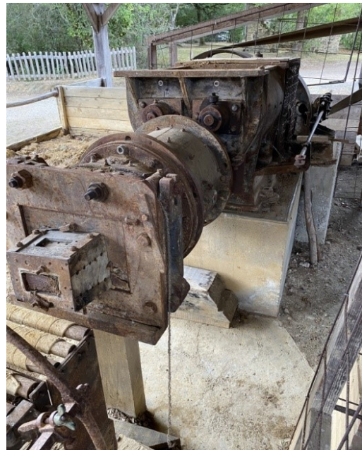
Figure 1. Extrudeuse pour la mise en œuvre et en forme de briques d'argile. Tuilerie de Pouligny (23220, Chéniers, Creuse).
